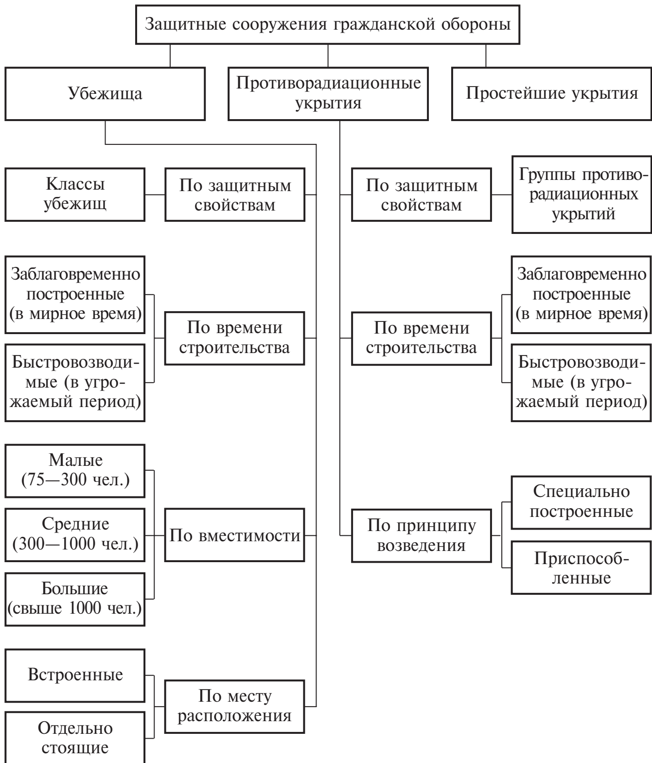
Рис. 6.4. Классификация защитных сооружений гражданской обороны
